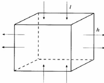
La deformación en la dirección horizontal tiene dos términos: el primero corresponde a la deformación producido por el esfuerzo de tracción, mientras que el segundo corresponde a la dilatación producida por la compresión en la dirección vertical. Por tanto, nos queda,
