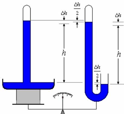
La figura ilustra la variación en los barómetros con el aumento de presión. Las alturas de las columnas de mercurio son iguales a  $(h + \Delta h)$ . Mientras la variación en el volumen de la cubeta corresponde al volumen de una columna de
