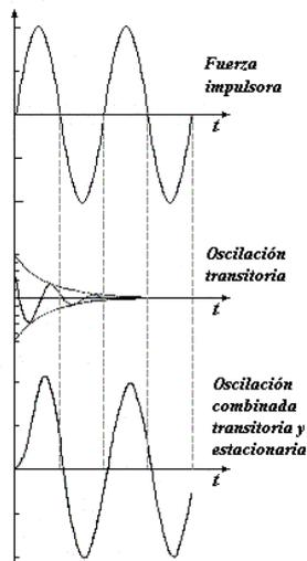
El comportamiento dependiente del tiempo real de un oscilador armónico amortiguado y forzado puede resultar muy complejo. La figura muestra la respuesta de un oscilador amortiguado frente a la acción de una fuerza impulsora de frecuencia  $\omega' = \frac{1}{2}\omega_o$ , suponiendo que el sistema está en reposo cuando la fuerza comienza a actuar. Obsérvese que una vez eliminado el comportamiento transitorio, únicamente persiste el movimiento estacionario con frecuencia  $\omega'$ .
