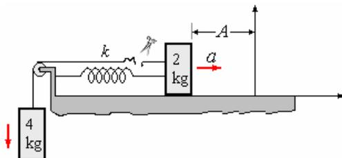
Vamos a aplicar la segunda ley de Newton ( $F = ma$ ) al cuerpo de masa 2 kg en el instante en que el resorte está comprimido una longitud  $x$
