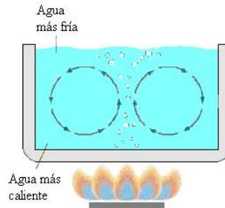
Las leyes que rigen el flujo de calor por convección son muy complejas porque involucra fenómenos de fluidos en movimiento y el cual todavía puede ser forzado o natural por diferencia de densidades. Sin embargo, se tiene una relación empírica dada por Newton, para un cuerpo dado:
