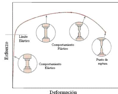
*Gráfica típica tensión vs deformación*
