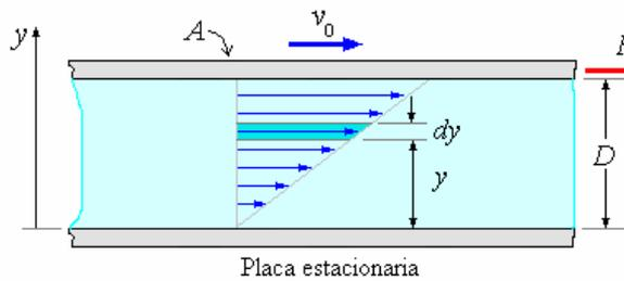
La placa superior bajo la acción de una fuerza constante  $F$  se mueve con una velocidad constante  $v_0$ . El fluido en contacto con la placa superior se adherirá y se moverá con velocidad  $v_0$ , y el fluido en contacto con la placa fija tendrá velocidad cero si la distancia  $D$  y la velocidad  $v_0$  no son muy grandes, la variación de velocidad será lineal.
