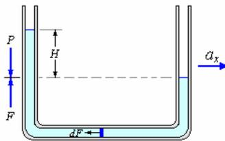
Como todos los elementos diferenciales de masa en la parte horizontal tienen la misma aceleración, la fuerza total será:
