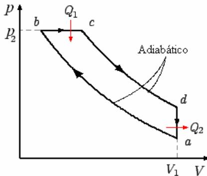
**Ejemplo 106.** Un motor diesel opera en el ciclo reversible *abcda*, con 9,0 moles de un gas ideal. Los procesos *ab* y *cd* son adiabáticos. Las temperaturas de los puntos *a*, *b*, *c* y *d* del ciclo son 250 K, 375 K, 540 K, 432 K, respectivamente. La constante adiabática del gas es 1,50.
