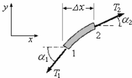
La cuerda tiene una masa uniforme  $\mu$  por unidad de longitud y está sometida a una tensión  $T$ . Sobre esta cuerda esta viajando una onda transversal.
