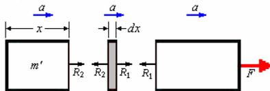
El elemento diferencial  $dm$  se mueve con aceleración  $a$  debido a la fuerza  $(R_1 - R_2)$
