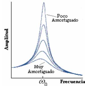
En la figura se muestra la respuesta en amplitud de la oscilación forzada, en el estado estacionario. Como podemos observar a partir de la fórmula o la gráfica, la amplitud de la oscilación forzada en el estado estacionario disminuye rápidamente cuando la frecuencia de la oscilación forzada  $\omega'$  se hace mayor o menor que la frecuencia propia del oscilador  $\omega_o$ .
