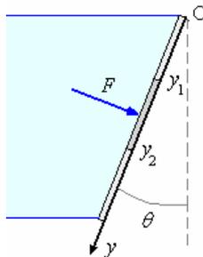
En una sección anterior se calculó la fuerza resultante y centro de la fuerza para un área vertical de sección rectangular. Para una sección rectangular inclinada un ángulo  $\theta$  con la vertical, el cálculo es muy parecido, pero ahora, el eje Oy está inclinado luego resultarán
