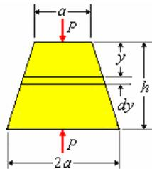
Según muestra el diagrama del cuerpo libre del elemento diferencial, es comprimido por la fuerza P. Este elemento disminuye su longitud d(Δh), siendo Δh la disminución de longitud de h debido a la fuerza P.
