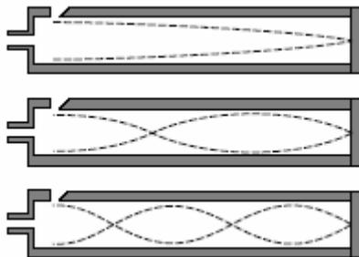
En esta situación se tendrá un nodo en  $x=0$  y un antinodo en  $x=L$ , lo que implica que en la longitud  $L$  de la cuerda han de caber un número impar de cuartos de onda. Aplicando la condición de antinodo reflexión en un límite fijo resulta:
