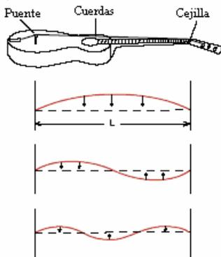
En este caso las condiciones a imponer son que, si la longitud del medio es  $L$ , tanto en  $x=0$  como  $x=L$  se habrán de dar nodos. Aplicando la condición de nodo en un límite fijo, resulta:
