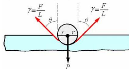
Si el objeto tiene forma esférica, que es aproximadamente la forma que tienen las patas de los insectos, la tensión superficial actúa en todos los puntos a lo largo de un círculo de radio  $r$ . Sólo la componente vertical,  $\gamma \cos \theta$ , actúa para equilibrar  $P$ . En consecuencia la fuerza neta ascendente debida a la tensión superficial es  $2\pi r \gamma \cos \theta$ .
