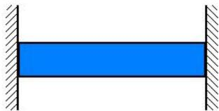
Al aumentar la temperatura  $\Delta t$ , debería producirse un cambio de longitud
