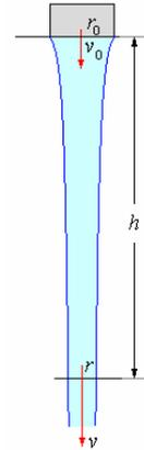
La sección transversal del chorro de agua cuando sale del caño es  $A_0$ , y la velocidad del agua es  $v_0$ . Debido a la acción de la gravedad la velocidad  $v$  del agua se incrementa. A una distancia  $h$  del grifo la velocidad es
