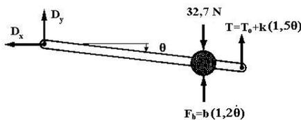
Aplicando la segunda ley de Newton para la rotación con el desplazamiento y velocidad indicados en la figura es:
