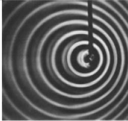
Consideremos Una fuente que se mueve hacia el observador con una velocidad  $v_f$  tal como muestra la figura. Si la frecuencia de la fuente es  $f$ , emite un frente de onda cada  $T$  segundos, donde  $T = 1/f$ . Por consiguiente, durante un periodo un frente de onda viaja una distancia  $vT$  mientras que la fuente emisora viaja una distancia  $v_f T$ . Como resultado el siguiente frente de onda es emitido a una distancia  $vT - v_f T$  detrás del frente previo, como muestra la figura.
