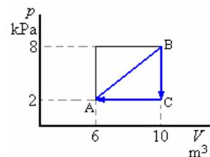
**Solución.**a)  $Q_{AB}$  = positivo $Q_{BC}$  = negativo (Dato) $(U_C - U_B) = Q_{BC} - W_{BC} = Q_{CA}$  = negativo $(U_A - U_B) = Q_{CA} - W_{CA} \Rightarrow Q_{CA} = (U_A - U_C) +$  $W_{CA} = (-) + (-) = \text{negativo}$
