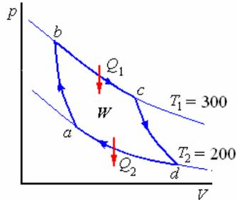
$a \rightarrow b$  Compresión adiabática reversible hasta que la temperatura se eleve a  $T_1$ .
