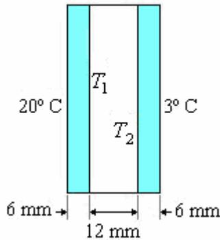
Sean  $T_1$  y  $T_2$  las temperaturas a la derecha del vidrio izquierdo e izquierda del vidrio derecho, respectivamente:
