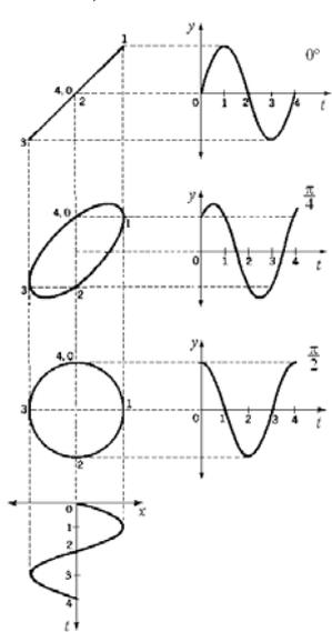
En general las oscilaciones bidimensionales no tienen por qué ser las mismas frecuencias en los mismos movimientos según las direcciones  $x$  y  $y$ , de forma que las ecuaciones se conviertan en
