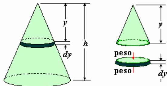
Este elemento sufre una acortamiento  $d(\Delta h)$ , debido al peso de la porción de cono que soporta (de altura  $y$ , radio de la base  $r$ ).
