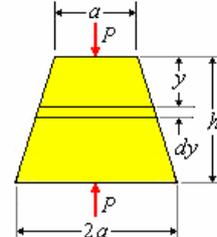
Según muestra el diagrama del cuerpo libre del elemento diferencial, es comprimido por la fuerza  $P$ . Este elemento disminuye su longitud  $d(\Delta h)$ , siendo  $\Delta h$  la disminución de longitud de  $h$  debido a la fuerza  $P$ .
