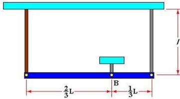
19. En el sistema mostrado en la figura, calcular cuánto descende el extremo B de la barra indeformable y de peso despreciable, cuando se le coloca un peso de 10 Ton. en ese extremo. Los tirantes son de acero y de  $2\text{cm}^2$  de área cada uno, suponga deformaciones pequeñas de tal manera que se puedan hacer las aproximaciones geométricas apropiadas.
