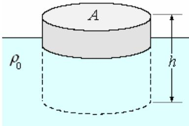
17. Considere una varilla de madera muy liviana, de largo  $L$ , sección transversal  $A$  y densidad  $\rho$ , que se hace flotar en el agua (designe la densidad del agua por  $\rho_0$ ).
