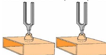
Enfrentadas las aberturas de las cajas y excitado un diapasón, se comprueba que el otro entra espontáneamente en vibración, En efecto, si se detiene con la mano el diapasón excitado en un principio, se percibe nítidamente el sonido producido por el otro y,
