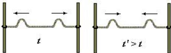
b) En el anillo fijo se produce cambio de fase en la reflexión. La propagación sigue los pasos de la figura.
