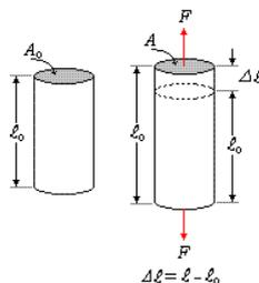
Por definición, El esfuerzo  $S$  en la barra es igual al cociente entre la fuerza de tensión uniaxial media  $F$  y la sección transversal original  $A_0$  de la barra.
