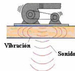
Para reducir la vibración que se percibe abajo, se va a fijar el equipo a una placa montada sobre resortes. El eje del ventilador gira a 1800 rpm (revoluciones por minuto) y la masa combinada de la unidad y la placa de montaje (véase la figura) es de 576 kg.
