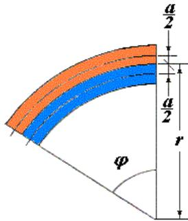
Vamos a suponer que la línea media de cada lámina conserva la longitud que tendría en estado no curvado. El radio  $r$  se determina por las condiciones
