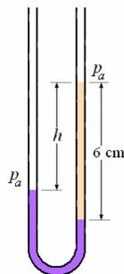
2. Un tubo en U que está abierto en ambos extremos se llena parcialmente con mercurio. Después se vierte agua en ambos lados obteniéndose una situación de equilibrio ilustrada en la figura, donde  $h_2 = 1 \text{ cm}$ . Determine la diferencia de altura  $h_1$  entre las superficies de los dos niveles de agua.
