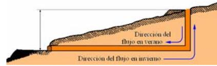
La ventilación en una mina responde a tres propósitos principales: para proporcionar el aire fresco para la respiración de los mineros, diluir los gases nocivos que puedan ser formados subterráneamente.
