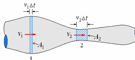
Consideremos un tubo de flujo constante de un líquido no viscoso; tal como el mostrado en la figura. Sean 1 y 2 dos sectores cuyas secciones tienen áreas normales al flujo  $A_1$  y  $A_2$ , con velocidades  $v_1$  y  $v_2$  respectivamente.
