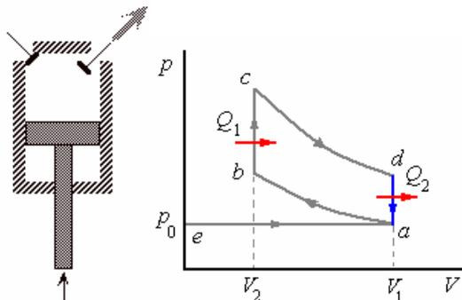
$a \rightarrow e$  Proceso isobárico a presión atmosférica, el volumen varía de  $V_1$  a cero, a temperatura constante.
