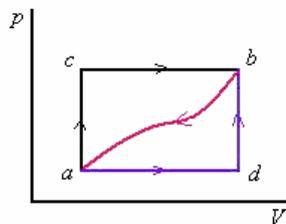
a) Cuando el sistema pasa de l estado  $a$  al  $b$  a lo largo de la trayectoria  $a, c, b$  recibe 20000 calorías y realiza 7500 cal de trabajo. Calcular el cambio de energía interna ( $U_b - U_a$ ).
