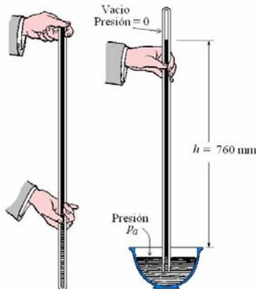
El extremo superior del tubo queda al vacío. Apliquemos la segunda ley de Newton a la columna de mercurio (que sobresale de la superficie del líquido en el recipiente). ¿Cuáles son las fuerzas que actúan sobre ella?
