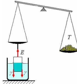
Para volver al equilibrio (balanza horizontal) se colocan las pesas en el platillo izquierdo de la balanza (peso  $Mg$ ), esto anula la acción del empuje  $E$  y a la fuerza de la tensión superficial  $F$ .
