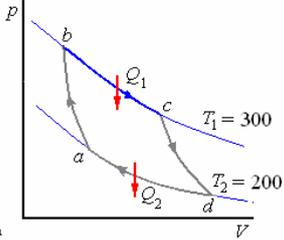
$c \rightarrow d$  Expansión adiabática reversible hasta que la temperatura baje a  $T_2$ .
