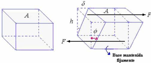
Cuando la fuerza  $F$  que actúa sobre el cuerpo es paralela a una de las caras mientras que la otra cara permanece fija, se presenta otro tipo de deformación denominada de cizalladura en el que no hay cambio de volumen pero si de forma. Si originalmente el cuerpo tiene forma rectangular, bajo un esfuerzo cortante la sección transversal se convierte en un paralelogramo.
