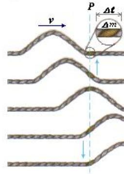
A un elemento de masa  $\Delta m$  en el punto P se le da una energía cinética a medida que un pulso de onda pasa con una velocidad  $v$ .
