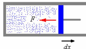
Si una de las paredes es un pistón móvil de área  $A$ , y éste se desplaza  $dx$ , el intercambio de energía del sistema con el mundo exterior puede expresarse como el trabajo realizado
