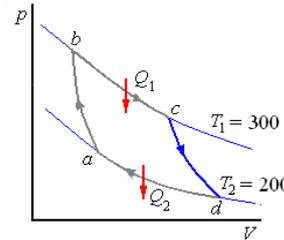
$d \rightarrow a$  Compresión isotérmica reversible hasta que se alcanza el estado original.
