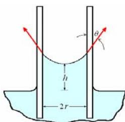
La tensión superficial  $\gamma$  actúa en un ángulo  $\theta$  alrededor de un círculo de radio  $r$ . La magnitud de la fuerza vertical  $F$  debida a la tensión superficial es  $F = (\gamma \cos \theta)(2\pi r)$ . Esta fuerza está equilibrada por el peso del líquido de abajo que es
