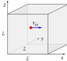
Sea  $N$  el número de moléculas del gas ideal de masa  $M$ , encerrado en un cubo de lado  $L$ . La molécula  $i$  se mueve con velocidad  $v_i$ , con  $v_{xi}$ ,  $v_{yi}$  y  $v_{zi}$  son sus componentes  $x$ ,  $y$  y  $z$  respectivamente.
