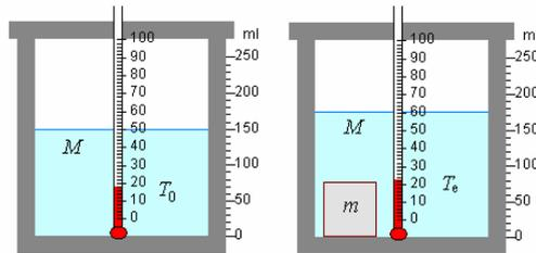
Se pesa una pieza de material sólido de calor específico  $c$  desconocido, resultando  $m$  su masa. Se pone la pieza en agua casi hirviendo a la temperatura  $T$ .
