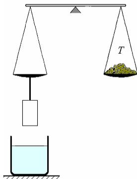
Cuando el cuerpo cilíndrico de vidrio cerrado se sumerge en agua aparecen las fuerzas de empuje y la de tensión superficial
