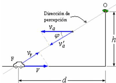
La velocidad del sonido en la dirección de percepción está afectada por la velocidad del viento, de tal modo que bajo estas condiciones  $v_s = (v - v'_a)$
