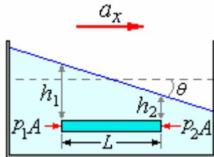
En la figura consideremos un prisma de líquido a lo largo de una línea horizontal. La presión no varía igual que en un líquido en reposo, por lo tanto el efecto de la aceleración  $a_x$  será en la dirección  $x$ .
