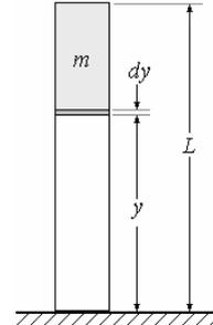
El elemento de columna  $dy$  es deformado por el peso de la masa  $m$ .
