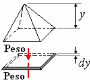
Este elemento sufre una acortamiento  $d(\Delta h)$ , debido al peso de la porción de pirámide que soporta (de altura  $y$ , radio base de lado  $2x$ ).
