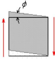
El cubo se deforma en el plano del papel y toma la forma de un rombo con ángulos
