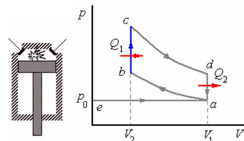
$c \rightarrow d$  Descompresión adiabática de acuerdo a la ecuación.  $T_c V_c^{\gamma-1} = T_d V_d^{\gamma-1}$
