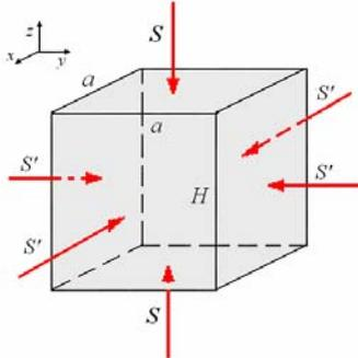
Sea  $S$  el esfuerzo sobre la cara superior e inferior y  $S'$  el esfuerzo sobre cada una de las caras laterales. La deformación del lado  $a$  es:
