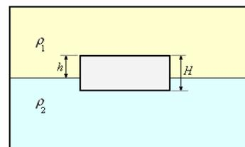
13. En una piscina se encuentra flotando una balsa que tiene forma de un paralelepípedo de densidad relativa (al agua) de  $0,3$  y cuyas dimensiones son  $120 \text{ cm}$  de largo,  $100 \text{ cm}$  de ancho y  $25 \text{ cm}$  de alto. Determine
