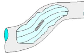
Tomemos una partícula de fluido de forma prismática (sección  $A$  largo  $\Delta s$ ) que se mueve a lo largo de una línea de flujo en la dirección  $s$ . La partícula prismática se muestra en detalle en la siguiente figura.
