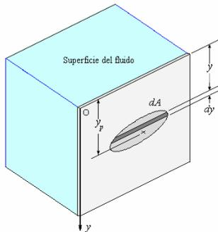
Para calcular la fuerza sobre superficie  $A$  en la pared vertical. Tomemos un elemento de área  $dA$  de ancho  $L$  y altura  $dy$  que se encuentra a una profundidad  $y$ . La fuerza sobre este elemento diferencial es:
