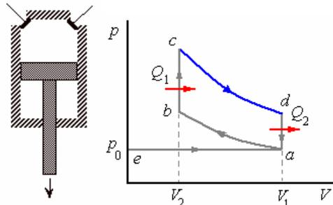
$d \rightarrow a$  Descompresión a volumen constante, la temperatura cambia de  $T_d$  a  $T_a$ . Este proceso es aproximado a la apertura de la válvula en el motor a gasolina.
