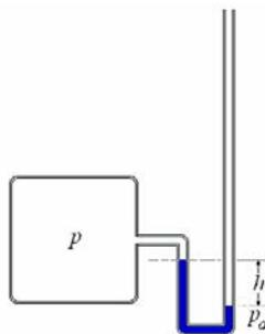
**Ejemplo 9.** Determinar la presión  $p$  de un gas, en el manómetro mostrado en la figura.
