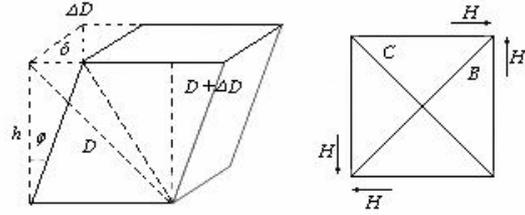
El esfuerzo de compresión sobre el plano  $B$  resulta ser
