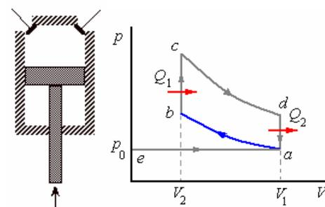
$b \rightarrow c$  Compresión isocórica (volumen constante) la temperatura cambia de  $T_b$  a  $T_c$ . Este proceso es aproximado a la explosión en el motor de gasolina.
