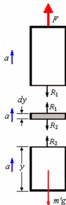
El elemento diferencial  $dm$  se mueve con aceleración  $a$  debido a la fuerza  $(R_1 - R_2)$
