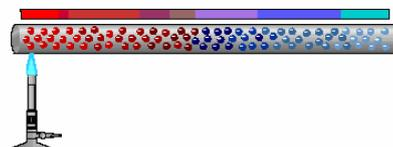
La expresión matemática fundamental de la conducción de calor es la generalización de los resultados de los experimentos en el flujo lineal de calor a través de una lámina de material de espesor  $\Delta x$  y de área  $A$ , una de las caras se mantienen a temperatura  $\theta + \Delta\theta$ , los resultado muestran que  $Q$  es proporcional al tiempo  $\Delta t$ .
