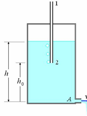
Consiste en un frasco lleno de fluido hasta una altura  $h_0$ , que está cerrado por un tapón atravesado por un tubo cuyo extremo inferior está sumergido en el líquido. El fluido sale del frasco por un orificio practicado en el fondo del recipiente. En el extremo inferior 2 del tubo, la presión es la atmosférica ya que está entrando aire por el tubo, a medida que sale el líquido por el orificio.
