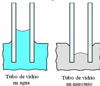
La cantidad real que sube (o que baja) depende de la tensión superficial (puesto que es ésta la que mantiene unida a la superficie del líquido), así como del ángulo de contacto  $\theta$ , y el radio  $r$  del tubo. Para calcular  $h$ , la altura que nos referiremos a la figura siguiente.
