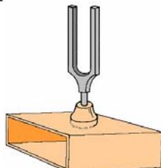
Si se lo excita, entra en vibración formándose una onda estacionaria; los nodos estarán ubicados a 2/3 de su longitud al emitirse el sonido fundamental. La frecuencia del diapasón depende de la elasticidad del material y su densidad.
